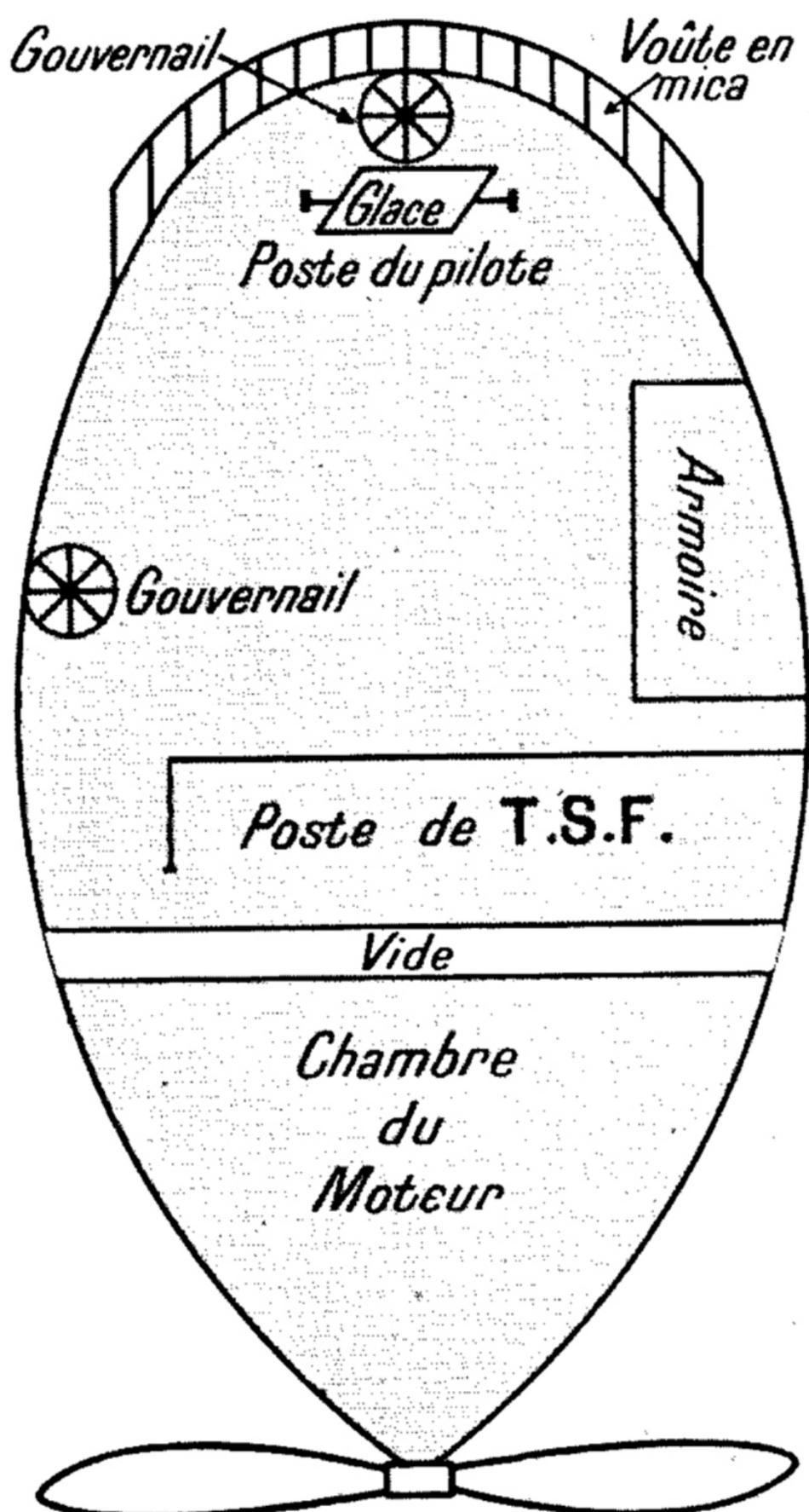
Plan schématique de la nacelle avant.
