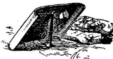
Sacs à terre et bouclier individuel en tôle d'acier de 7 <sup>m</sup>/<sub>m</sub>, avec un trou de tireur pouvant être obturé par une paupière à pivot.
