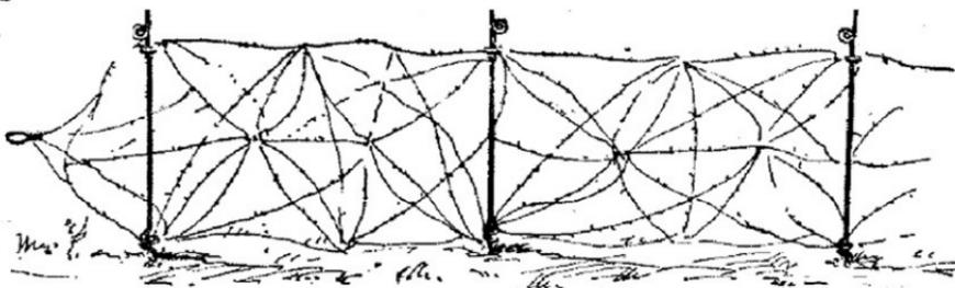
Réseau extensible avec montant d'un mètre de hauteur se vrillant dans le sol.
