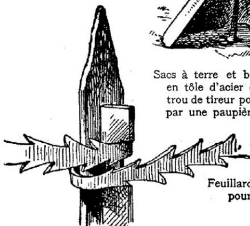
Feuillard d'acier sur pieux en fer pour réseaux de 2<sup>e</sup> ligne.
