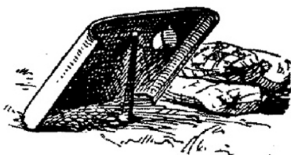
Sacs à terre et bouclier individuel en tôle d'acier de 7 m , avec un trou de tireur pouvant être obturé par une paupière à pivot.
